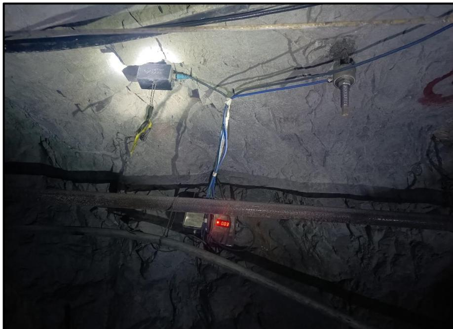
图 2-27 松兰矿区地压人工监测设施照片
