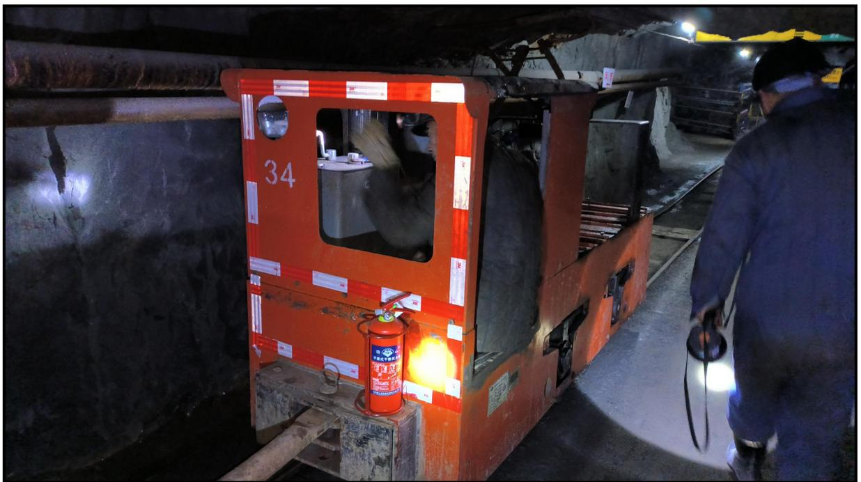
图 2-7 矿用架线式电机车
